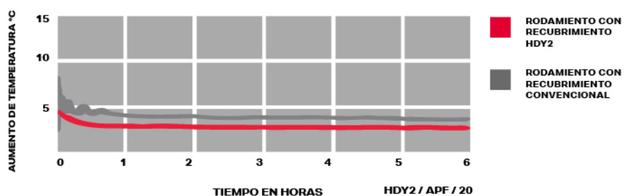
FIG. 4 - RENDIMIENTO DE DISIPACIÓN DE CALOR (6311 PISTA EXTERIOR)
